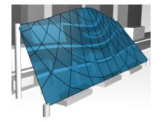
(d) Paneling solution using 1/4° kink angle threshold (divergence: 1.6mm; cost: 998).
